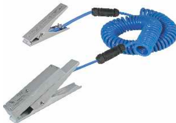
Bond-Rite® EZ avec voyant LED vert intégré à la pince, qui clignote lorsque une connexion d'une résistance égale ou inférieure à 10 ohms est établie entre un équipement mis à la terre et un équipement portable conducteur.
